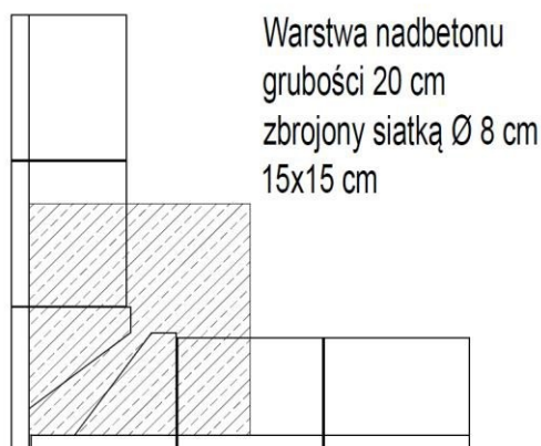
Obr. 8 Schéma vykonania rohu s vrstvou betónového obloženia.
